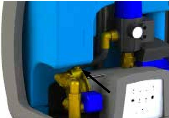
1 NL: Ontlucht en vul de pomp in het toestel. Draai de vuldop eraf en vul de pomp volledig met schoon water. Draai de vuldop vervolgens handvast aan en open de afsluitkraan in de drinkwatertoevoer. En open vervolgens een aftappunt in de persleiding en steek de stekker in een 230V wandcontactdoos. De pomp start dan op. Sluit dan het aftappunt. De pomp brengt dan zijn maximale druk en slaat dan af.
