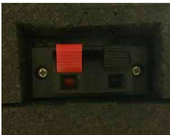
8 NL: Sluit nu de kabel van de vlotterschakelaar aan op het toestel. Gebruik hiervoor de speakerklemmen onderaan de Watermanager. Sluit de blauweader van de kabel van de vlotter schakelaar aan op de rode klem. Sluit daarna de bruineader van de kabel van de vlotter schakelaar aan op de zwarte klem. Druk de ongeïsoleerde aders diep in de klem en sluit deze. De geel / groene kabel (aarde) hoeft niet aangesloten te worden.
